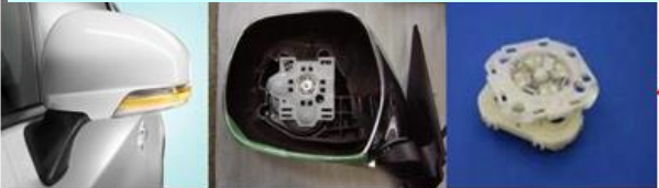
電動後照鏡內的角度調整驅動齒輪模組
